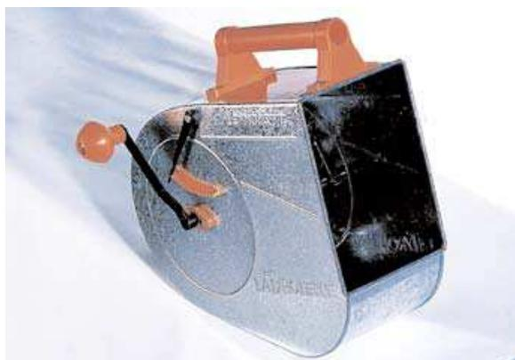
Cette action a pour but d'éjecter avec précision la matière hors de la machine en millions de gouttelettes. La machine permet d'obtenir facilement des plus beaux crépis du plus fin aux plus variés par projection de ciments, mortiers, mélanges tout-prêt.
